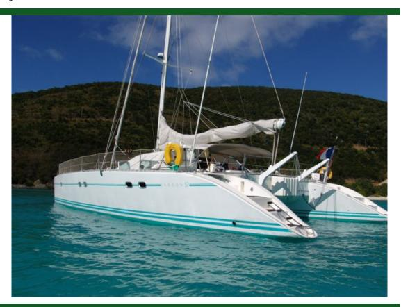
种类 现代 游艇类型 帆船 船身类型 双体船 载客量 16.9m (56 ') 船宽 9.2m (31') 吃水 1.2m (4') 船身材料 玻璃钢 发动机 2 / Yanmar / 发动机功率/HP 75
