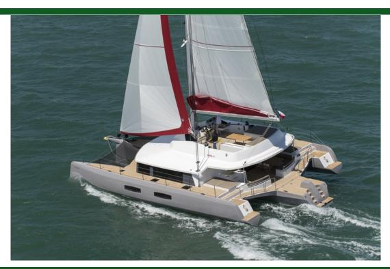
种类 现代 游艇类型 帆船 船身类型 三体船 载客量 19.8m (65 ') 船宽 12.0m (40') 吃水 1.8m (6') 船身材料 玻璃钢 1 / Volvo / 发动机 发动机功率/HP 150
