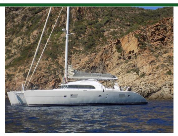
种类现代游艇类型帆船船身类型双体船载客量17.0m (56 ' )船宽9.1m (30')吃水1.4m (5')船身材料玻璃钢
