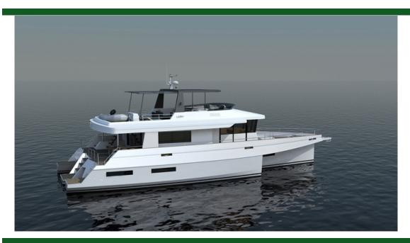
种类 现代 游艇类型 机动游艇 船身类型 三体船 载客量 21.8m (72') 船宽 8.9m (30') 吃水 1.2m (4') 玻璃钢 船身材料 发动机 3//
