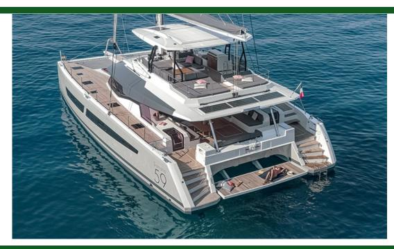
种类 现代 游艇类型 帆船 船身类型 双体船 18.8m (62 ') 载客量 船宽 9.5m (32') 吃水 1.6m (6') 玻璃钢 船身材料 发动机 2 / Volvo /
