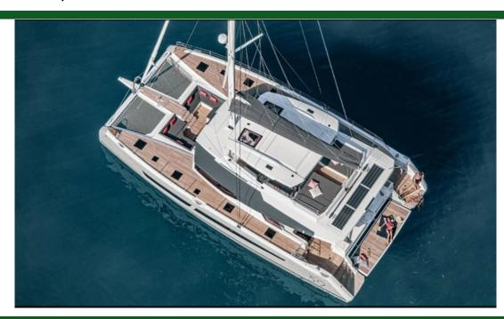
种类 现代 帆船 游艇类型 船身类型 双体船 18.8m (62 ') 载客量 船宽 9.5m (32') 1.6m (6') 吃水 船身材料 玻璃钢
