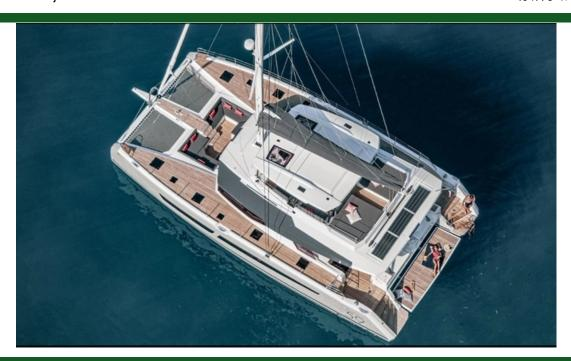
种类现代游艇类型帆船船身类型双体船载客量18.8m (62 ' )船宽9.5m (32')吃水1.6m (6')船身材料玻璃钢
