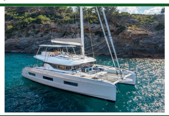
种类 现代 游艇类型 帆船 船身类型 双体船 载客量 18.3m (61 ') 9.9m (33') 船宽 吃水 1.6m (6') 船身材料 玻璃钢 发动机 2// 发动机功率/HP 150
