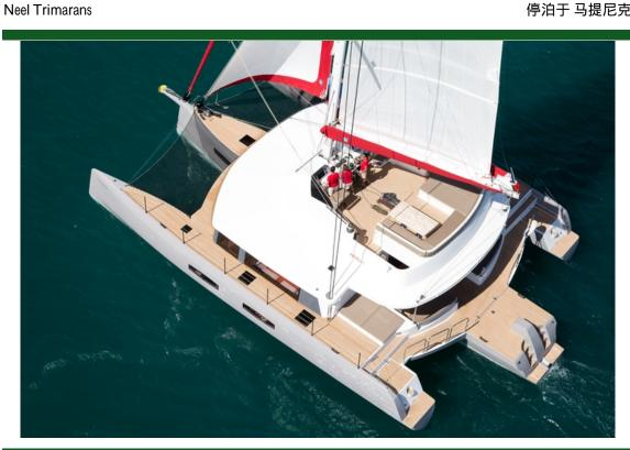
种类 现代 游艇类型 帆船 船身类型 三体船 载客量 19.8m (65 ') 12.0m (40') 船宽 吃水 1.8m (6') 船身材料 玻璃钢
