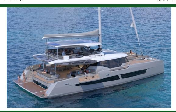
种类 现代 游艇类型 帆船 船身类型 双体船 载客量 24.0m (79 ') 11.1m (37') 船宽 吃水 2.1m (7') 船身材料 玻璃钢 发动机 2// 发动机功率/HP 270
