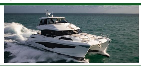
现代 种类 游艇类型 机动游艇 船身类型 双体船 载客量 21.3m (70 ') 船宽 8.2m (27') 吃水 1.4m (5') 玻璃钢 船身材料 发动机 2 / Volvo / D13
