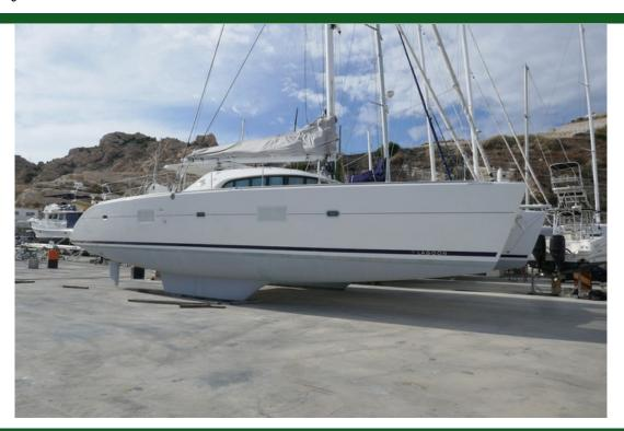
种类现代游艇类型帆船韶身类型双体船载客量17.0m (56 ' )船宽9.1m (30')吃水1.4m (5')船身材料玻璃钢
