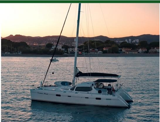
Moderno Tipo Propulsión Vela Casco Catamarán Eslora 17.8m (59') Manga 9.2m (31') 1.7m (6') Calado Construcción Fibra de vidrio Motor 2 / Volvo / TAMD31L
