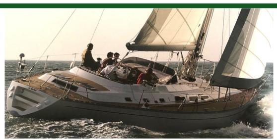
Tipo Moderno Propulsión Vela Casco Mono Eslora 17.0m (56') Manga 4.9m (17') 2.2m (8') Calado Construcción Fibra de vidrio
