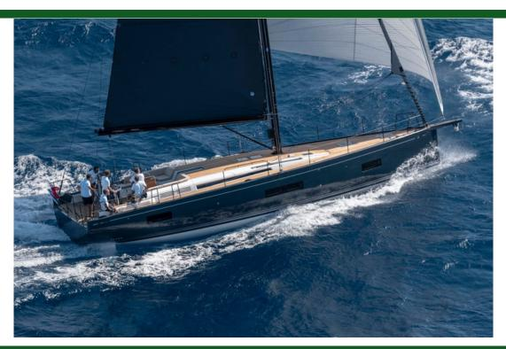
Tipo Moderno Propulsión Vela Casco Mono Eslora 17.1m (57') Manga 5.0m (17') 2.5m (9') Calado Construcción Fibra de vidrio 1 / Yanmar / Motor Potencia motor 80
