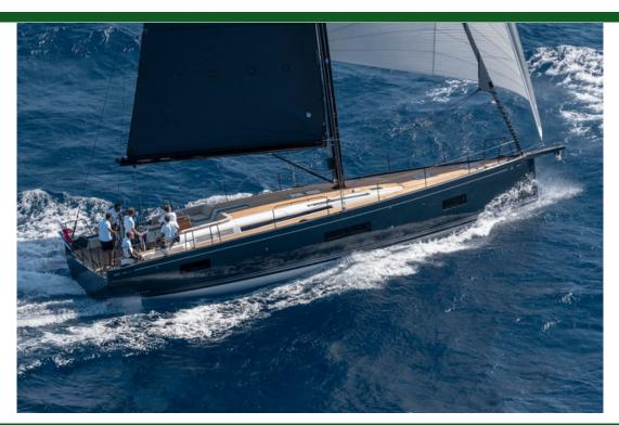
Tipo Moderno Propulsión Vela Casco Mono Eslora 17.1m (57') Manga 5.0m (17') 2.5m (9') Calado Construcción Fibra de vidrio 1 / Yanmar / Motor
