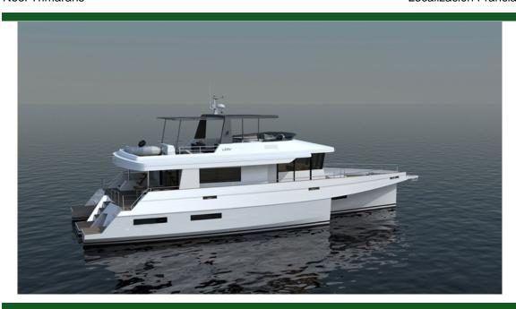
Tipo Moderno Propulsión Motor Casco trimarán Eslora 21.8m (72') Manga 8.9m (30') Calado 1.2m (4') Fibra de vidrio Construcción
