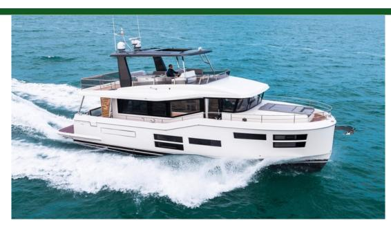
Tipo Moderno Propulsión Motor Casco Mono Eslora 19.0m (63') 5.4m (18') Manga Calado 1.4m (5') Construcción Fibra de vidrio 2 / Man / i6 730 Motor
