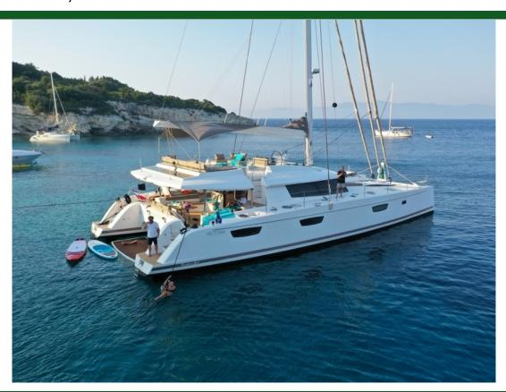
Tipo Moderno Propulsión Vela Casco Catamarán Eslora 21.7m (72') Manga 9.5m (32') Calado 1.9m (7') Construcción Fibra de vidrio 2 / Volvo / D3-150 Motor
