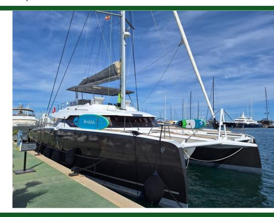
Moderno Tipo Propulsión Vela Casco Catamarán Eslora 19.5m (64') Manga 9.8m (33') Calado 1.7m (6') Construcción Fibra de vidrio 2 / Yanmar / 4LV170 Motor
