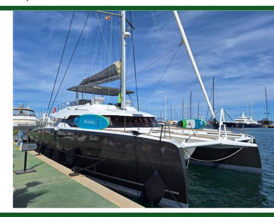
Tipo Moderno Propulsión Vela Casco Catamarán Eslora 19.5m (64') Manga 9.8m (33') Calado 1.7m (6') Construcción Fibra de vidrio 2 / Yanmar / 4LV170 Motor
