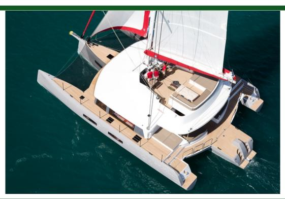
Moderno Tipo Propulsión Vela Casco trimarán Eslora 19.8m (65') 12.0m (40') Manga Calado 1.8m (6') Construcción Fibra de vidrio Motor 1 / Volvo / D3-150
