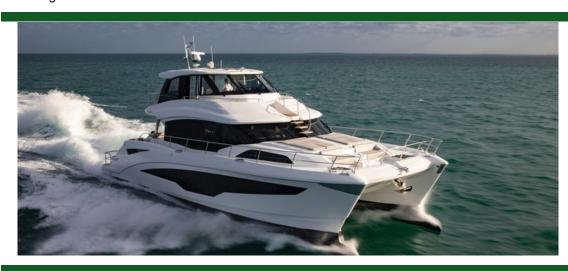
Tipo Moderno Propulsión Motor Casco Catamarán Eslora 21.3m (70') 8.2m (27') Manga 1.4m (5') Calado Construcción Fibra de vidrio Motor 2 / Volvo / D13
