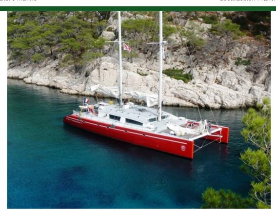
Tipo Moderno Propulsión Vela Casco Catamarán 24.9m (82') Eslora Manga 11.5m (38') Calado 2.1m (7') Construcción Composite 2 / Nanni / Motor Potencia motor 115
